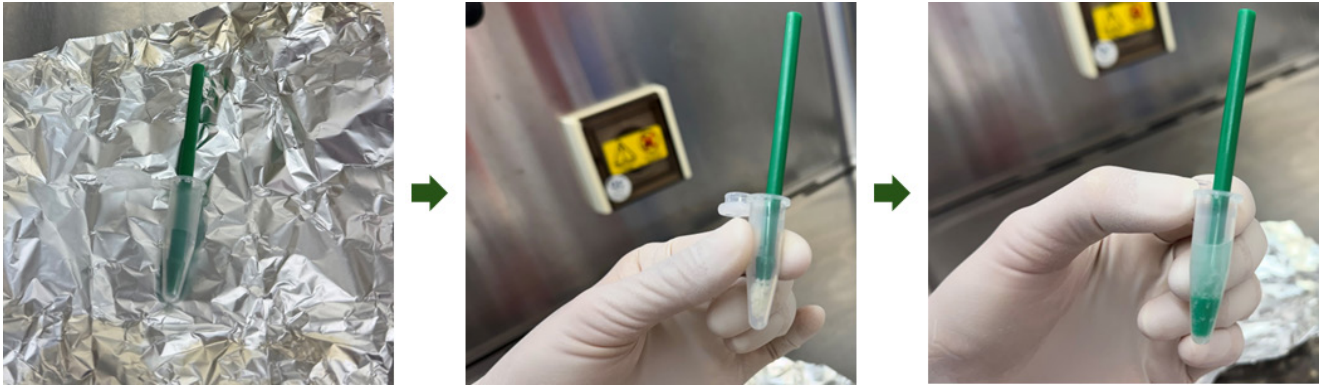
그림 1. (왼쪽) 마이크로튜브에 든 절굿공이. (가운데) 검체를 넣음. (오른쪽) 0.5 mL PBS 첨가 후 균질화시킴. 균질화 후 절굿공이를 제거하고 0.5 mL의 PBS를 더 첨가. 전 과정은 생물학적 안전상자 내에서 시행
