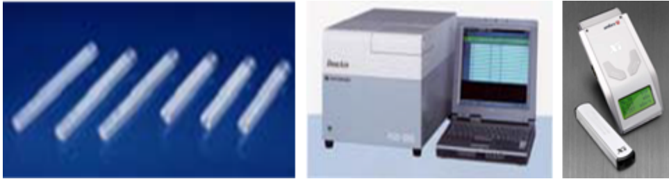
[그림 6] 측정에 사용된 유리선량계 소자(좌)와 리더기(DoseAce FGD-1000, 가운데) 및 Unfors 서베이미터(우)
