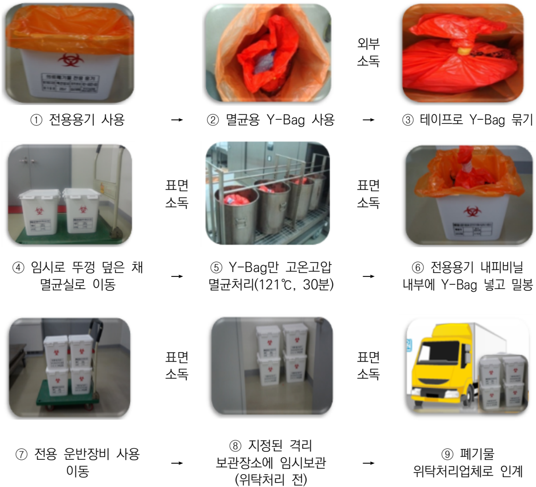
〈그림 30〉 격리의료폐기물을 고압증기멸균기로 처리 후 배출 할 경우 처리 절차
